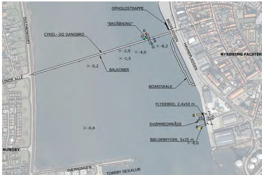
Figur 1 - Oversigtsplan over delelementer som skal ligge på søterritoriet ifm. Helhedsplanen for Nykøbing F. Havn
